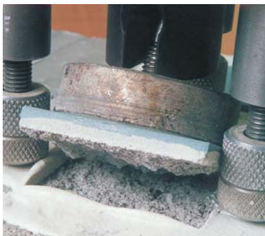
Màxima adhesió: ruptura pel formigó.
