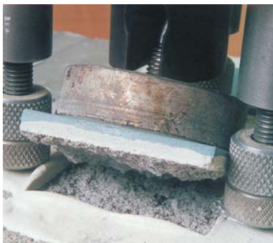
Máxima adherencia: rotura por el hormigón.
