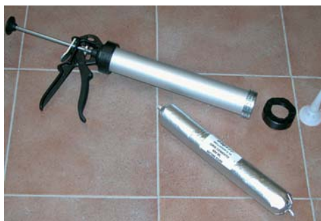
Utiliser un pistolet spécial pour les sachets en berlingot.
