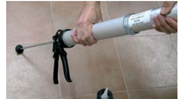
Mettre le sachet en berlingot dans le pistolet.
