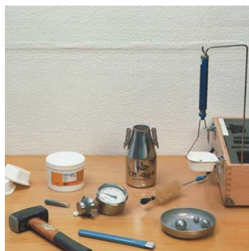
La humedad residual se mide con un Higrómetro de carburo de calcio.
