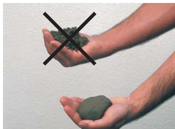
Añadir agua hasta obtener un mortero que tenga una consistencia de "arena mojada."
