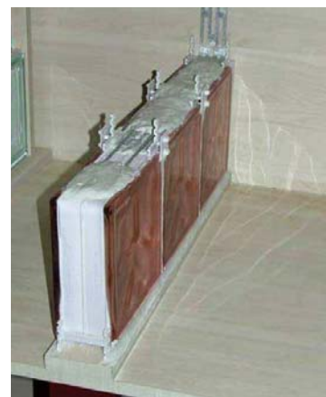
Usar cruceas de plástico y varillas galvanizadas.
