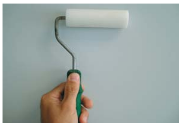
Para aplicar FIX-OIL usar un rodillo de lacar.
