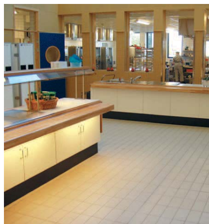
Rejuntat anti-àcid, impermeable i higiènic.
